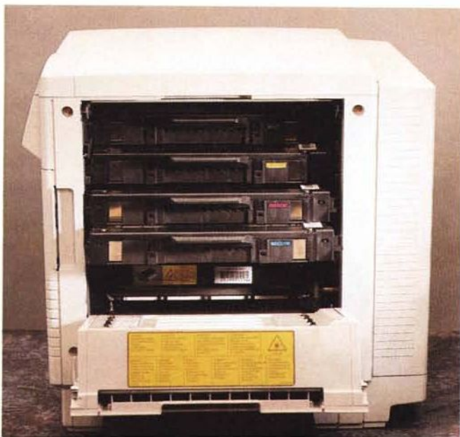
Sul retro della stampante troviamo le porte di interfacciamento. Sul lato frontale «image unit» e «gruppo di fusione»; i quattro toner sono accessibili lateralmente.
